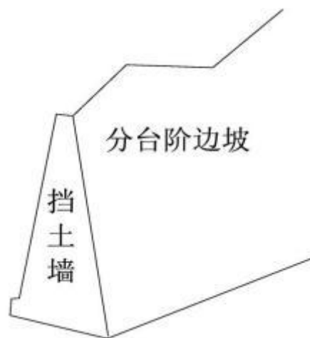
图 5.2-1 挡土墙断面图
