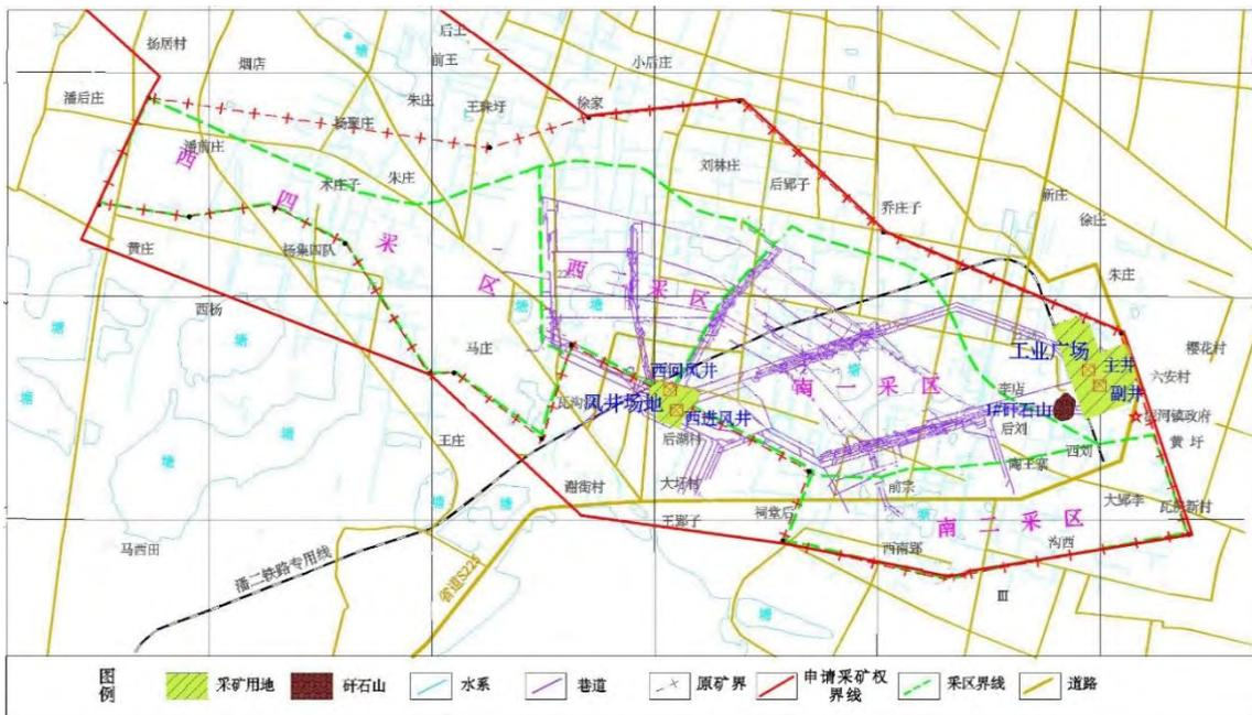
图 1-5 原潘二煤矿工业布局及井田开拓系统平面图
