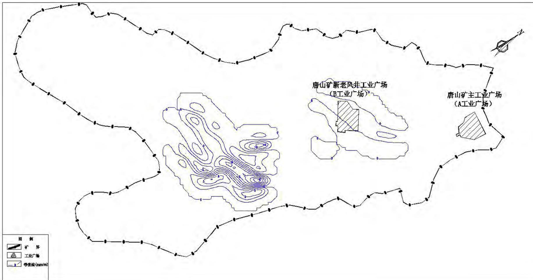
图 3.3-6 唐山矿第一阶段开采后地表最大水平变形等值线预计图
