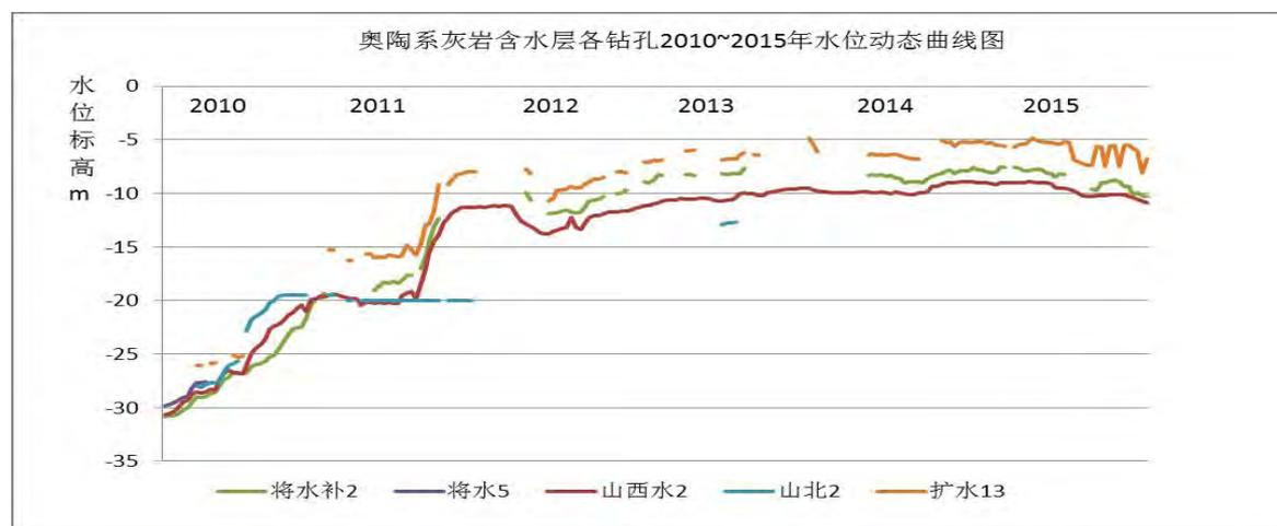
图 3.2-11 奥陶系灰岩含水层各钻孔 2010~2015 年水位动态曲线图
