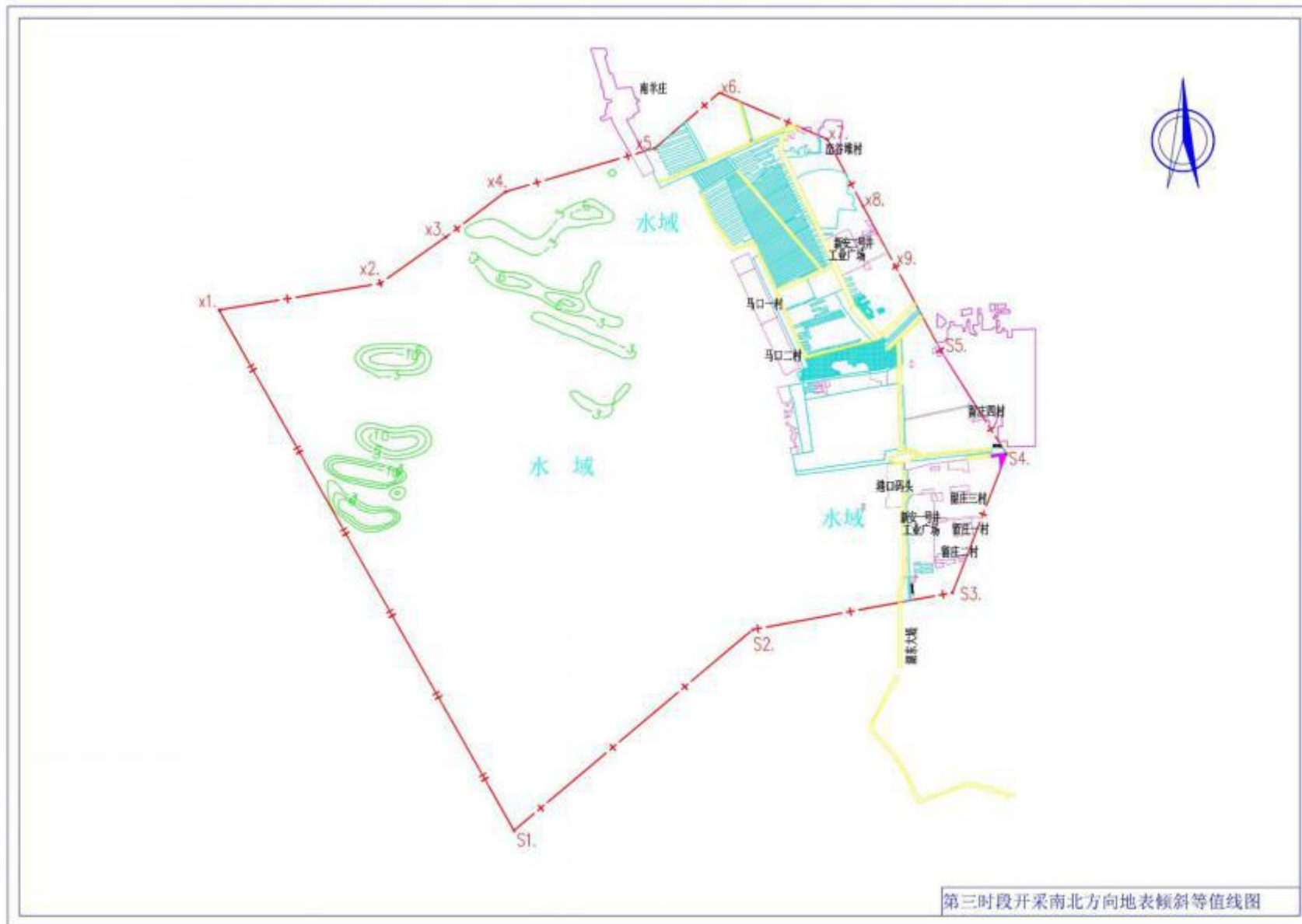
图 3-30 第三时段开采后南北方向地表地表倾斜等值线图
