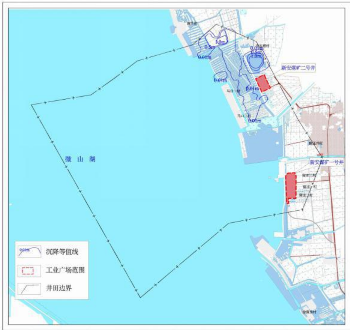
图 3-13 新安煤矿现状塌陷等值线图 塌陷区现状见图 3-13。
