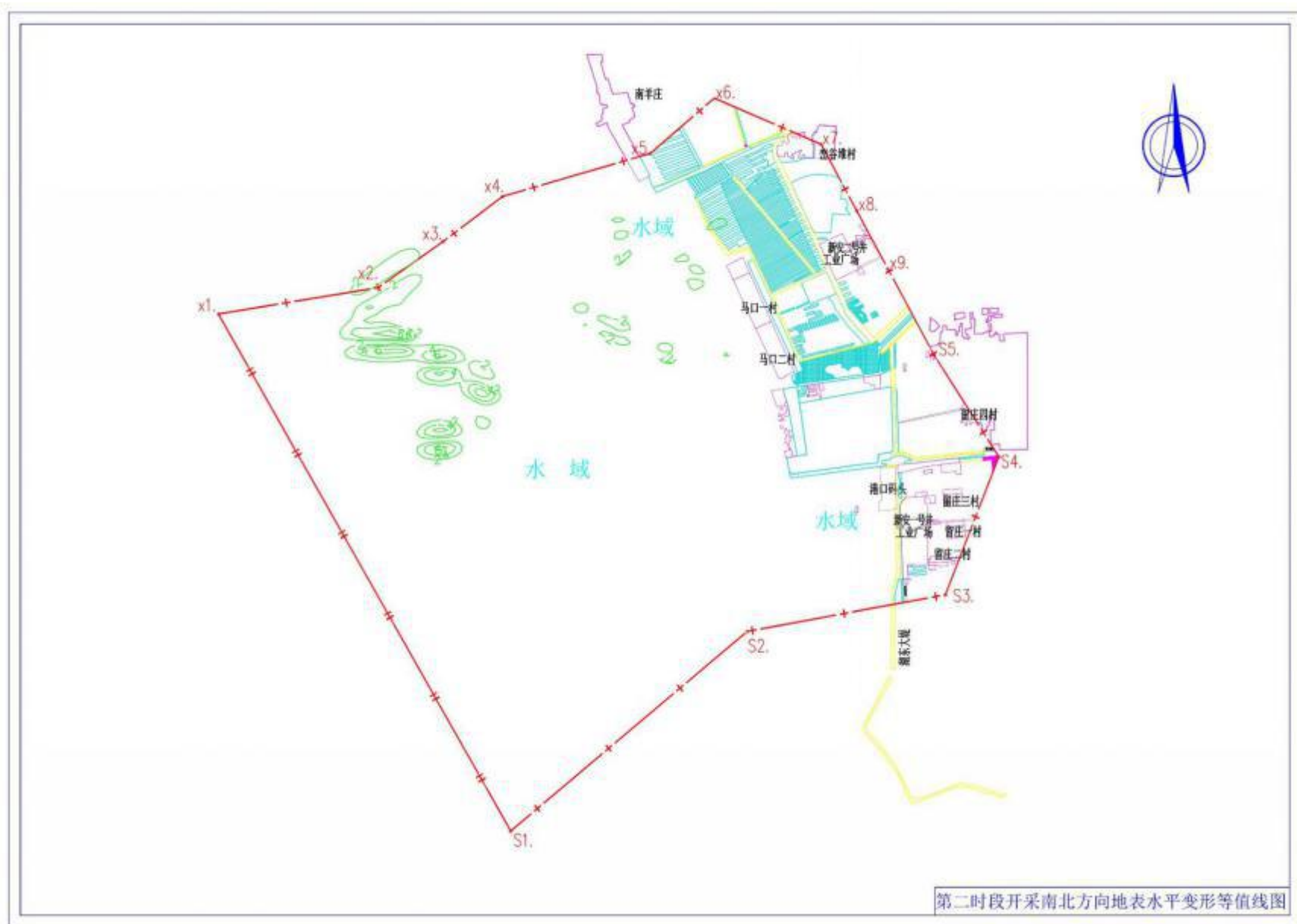
图 3-27 第二时段开采后南北方向地表水平变形等值线图
