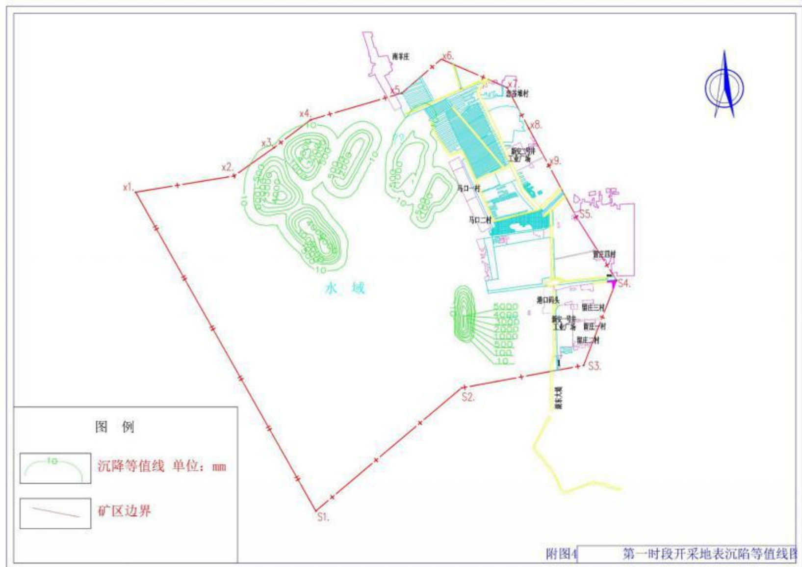
图 3-19 第一时段开采后地表沉陷等值线图
