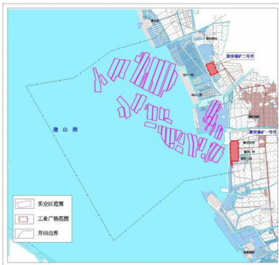
图 3-10 新安煤矿 3 (3 上 ) 煤层采空区分布图
