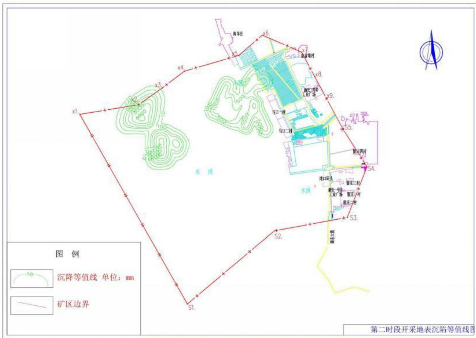
图 3-24 第二时段开采后地表沉陷等值线图
