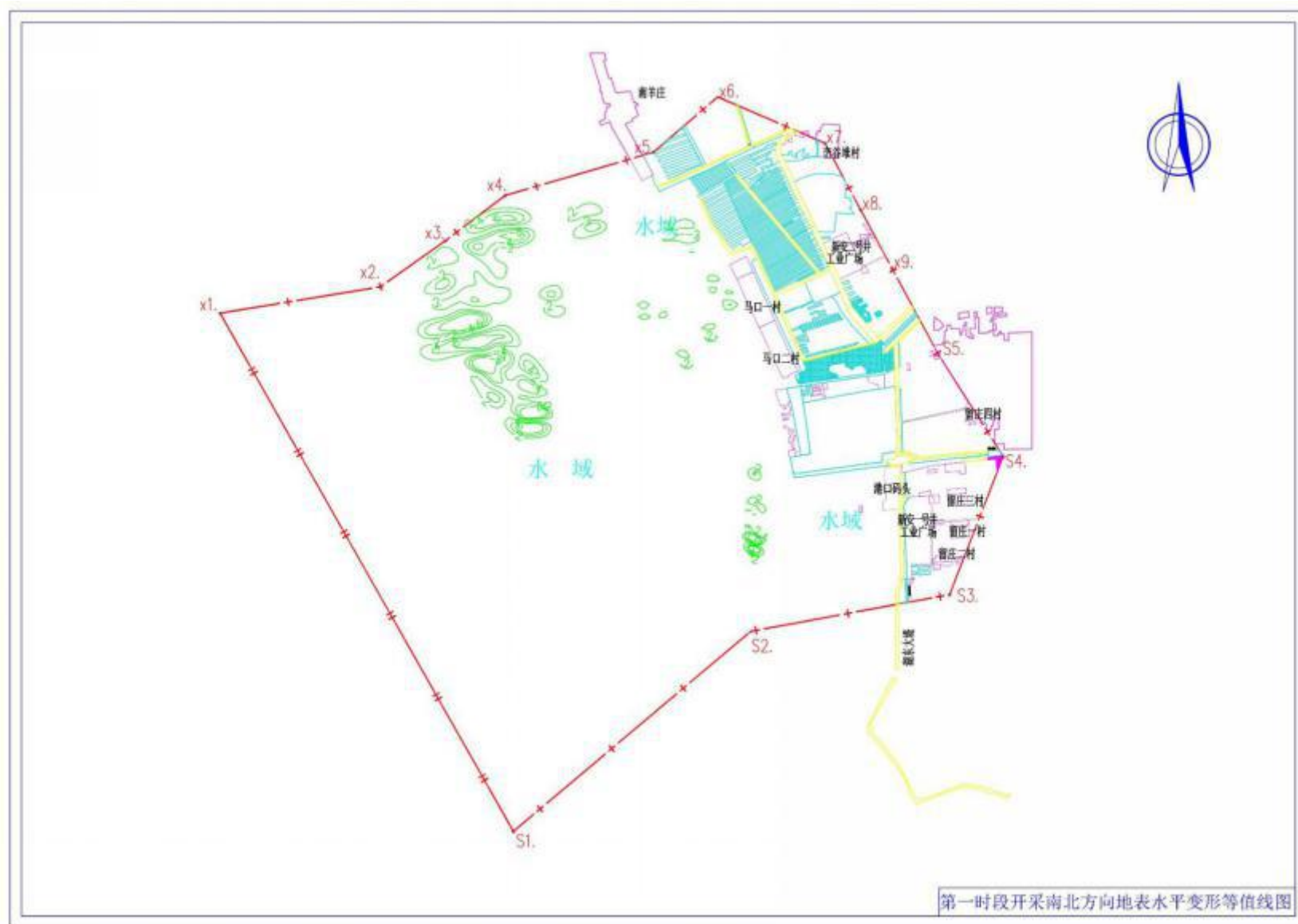
图 3-22 第一时段开采后南北方向地表水平变形等值线图
