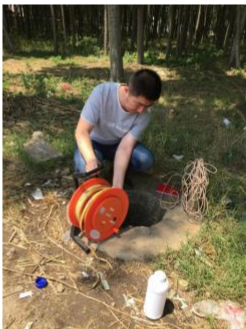
图 3-3 项目区机井潜水位测量照片
