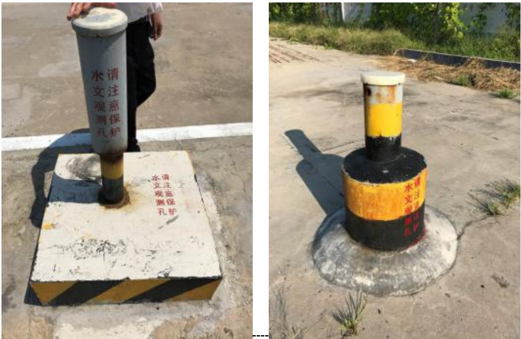
图 5-12 已布设基岩水监测孔（加装自动监测仪）
