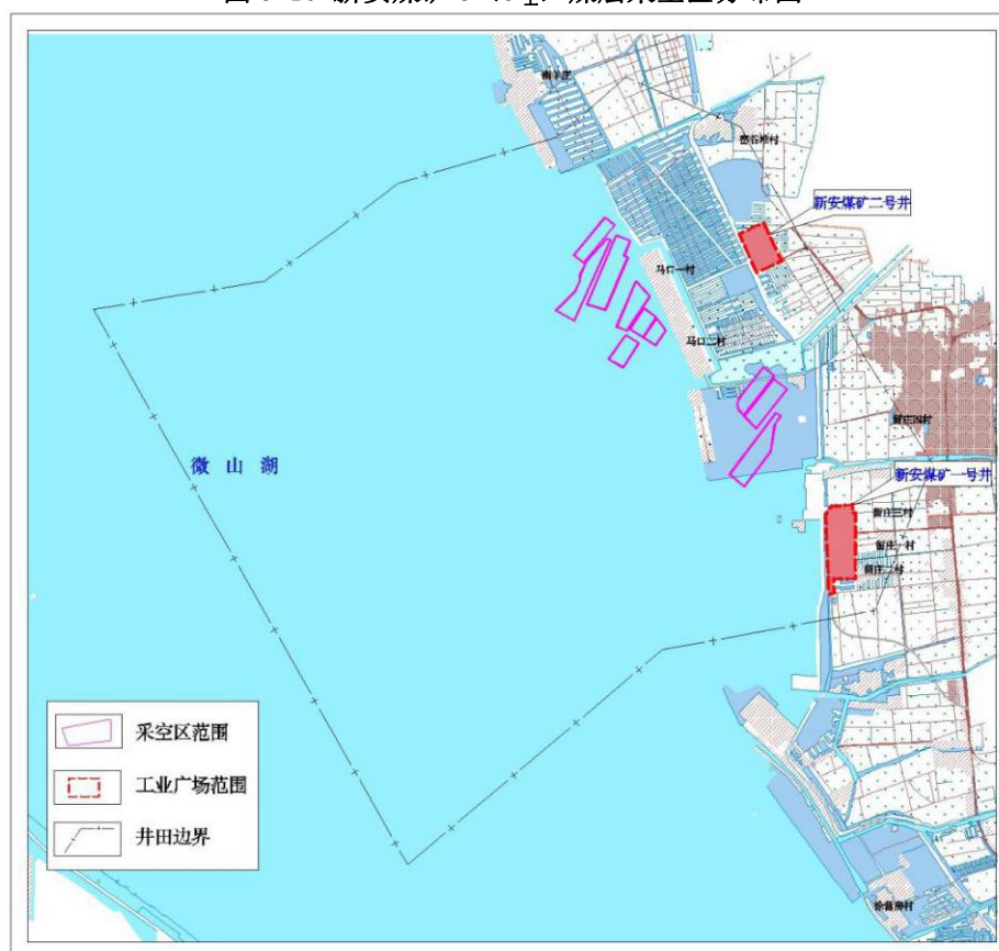
图 3-11 新安煤矿 3 下 煤层采空区分布图
