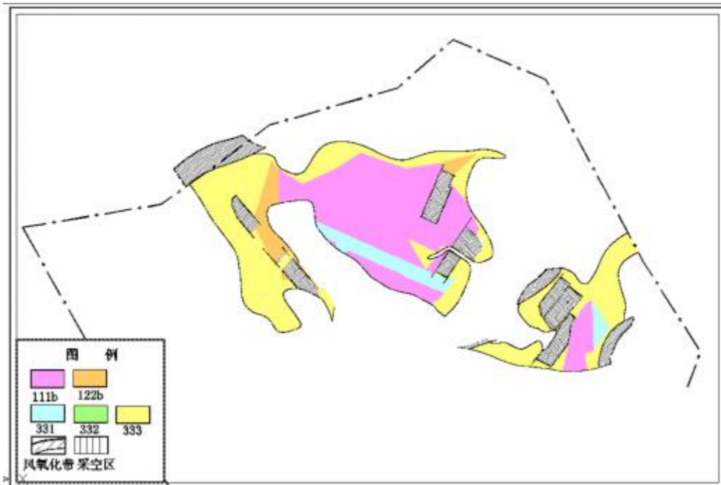
图 1-12 3 下 煤层资源储量估算图
