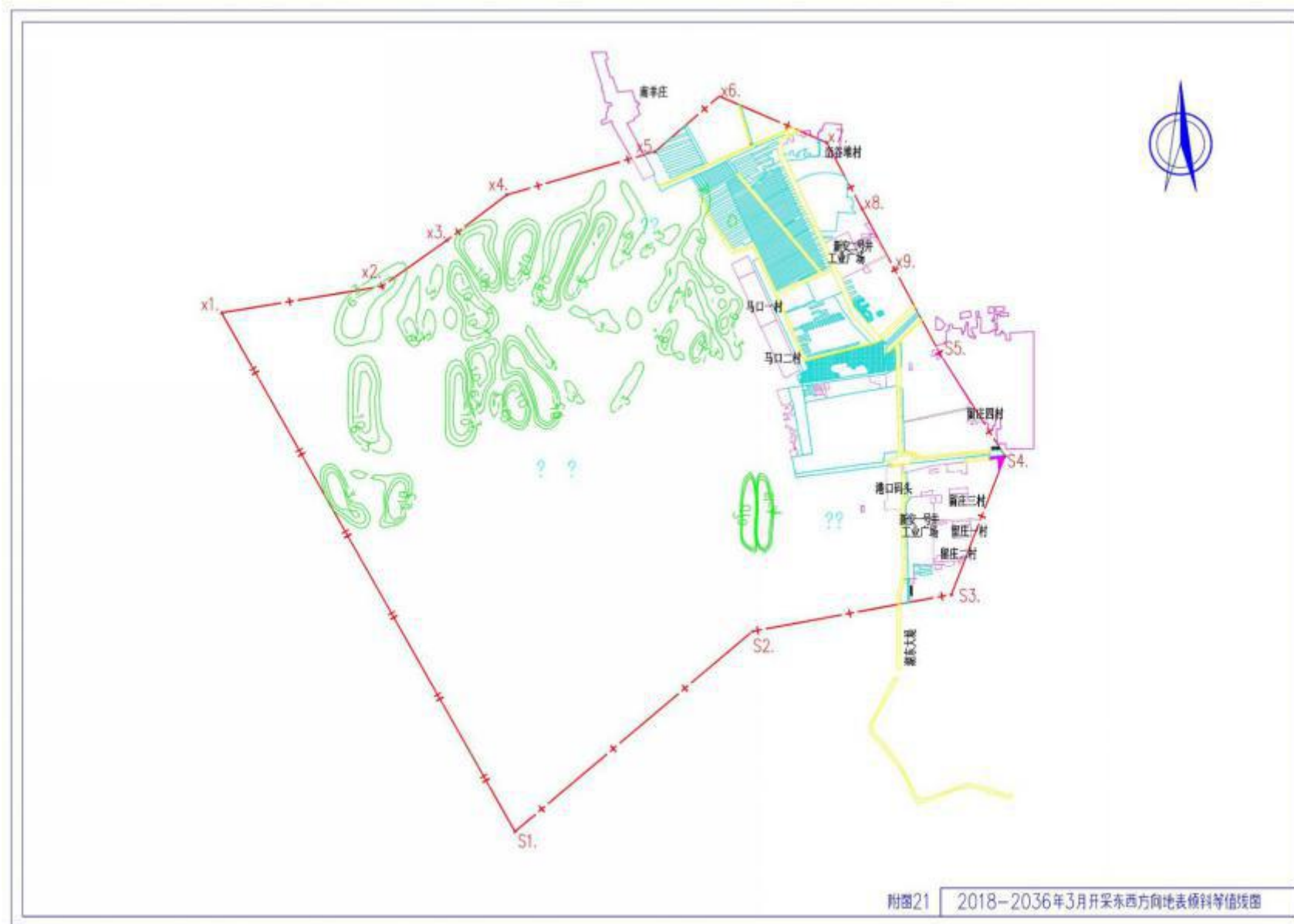
图 3-36 2018-2036 年 3 月开采后东西方向地表倾斜等值线图
