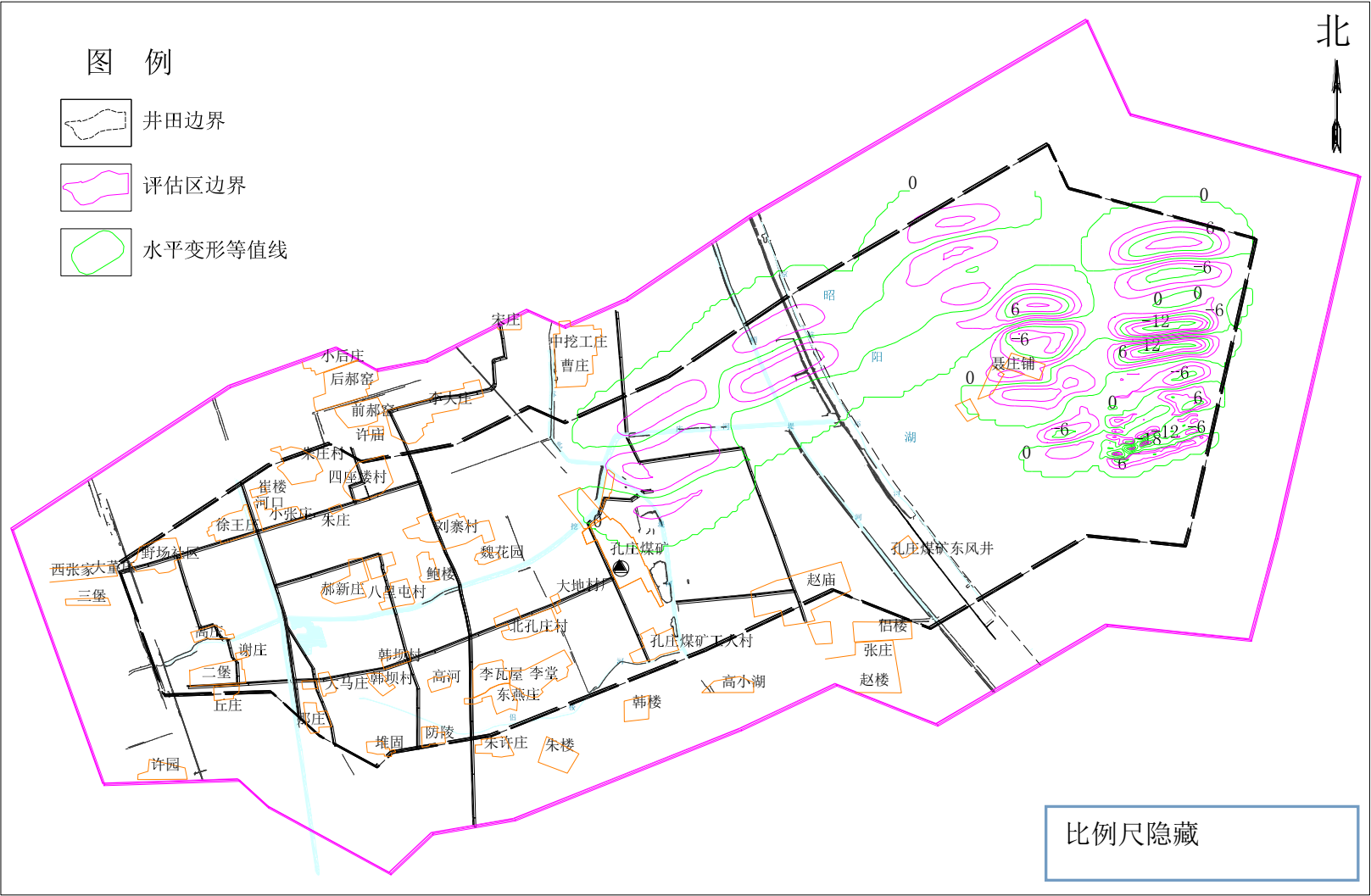
图 3.2-10 矿山地表移动变形水平变形等值线图（方案服务期）
