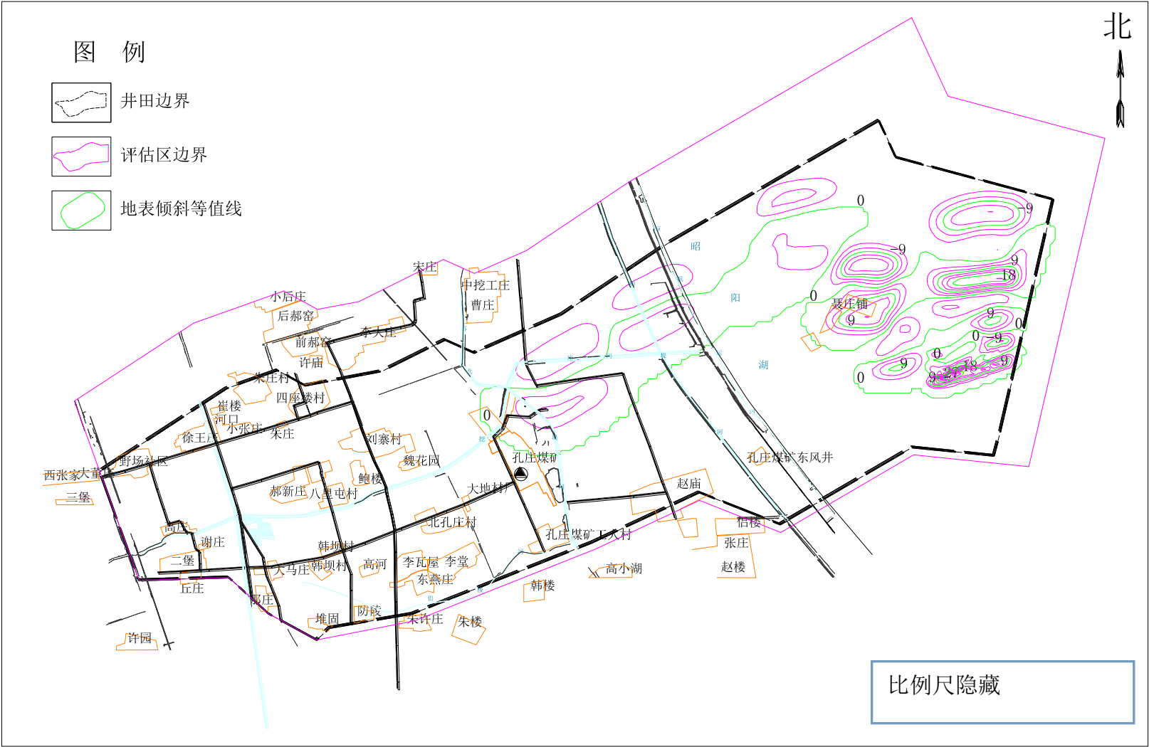
图 3.2-8 矿山地表移动变形倾斜等值线图（方案服务期）
